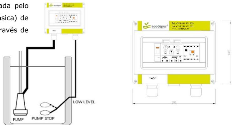
**A Estação Elevatória Compacta ECODEPUR® ECO BST e ECODEPUR® ECO BST PLUS** é comandada pelo quadro elétrico EPIC 2D, com controlo e proteção de duas bombas submersíveis mono ou trifásicas com alternância automática, controlado por 4 interruptores de nível tipo bóia, podendo ainda ser comandado por sonda analógica (por exemplo, um sensor piezométrico).
