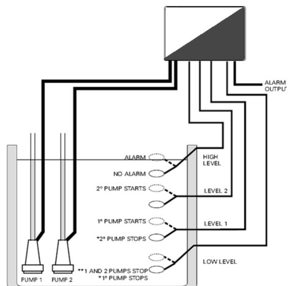
As bóias são alimentadas com tensão reduzida de segurança (2,7 V) de modo a não constituírem perigo de eletrocussão em caso de danificação, e as bombas são protegidas por relés eletrónicos de sobrecarga.
